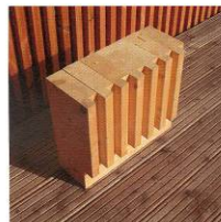
Échantillon du matériau de structure composé de lattes de bois clouées entre elles
